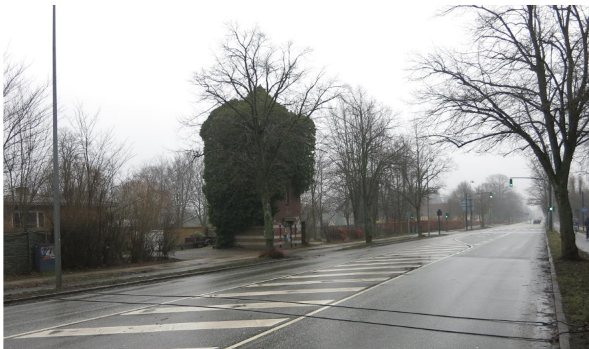
Figur 1: Foto af en trafiktælling med slanger der registrerer trafikmængder, køretøjstype og hastigheder.
