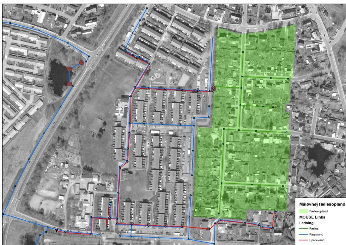
Figur 10: Oplandene i den hydrauliske model, hvor det reducerede areal er justeret for at kunne leve op til det fremtidige serviceniveau som er CDS = 10 år med klimafaktor 1,56.
