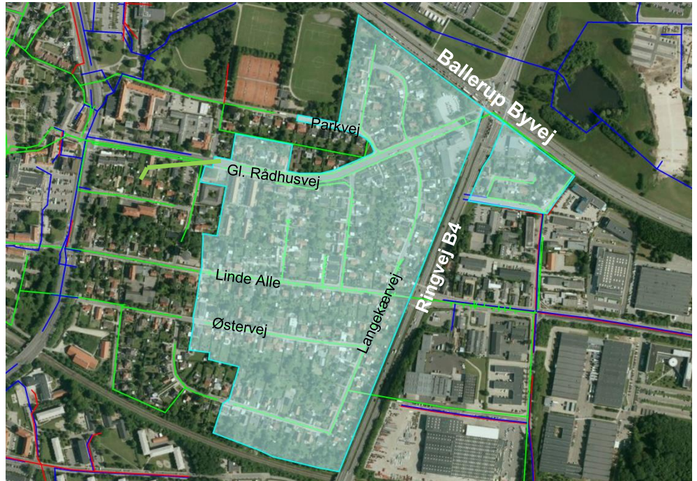
Figur 1 Den østlige del af Ballerup Bymidte. Opland B24F. Fællessystemet er vist med grøn.
