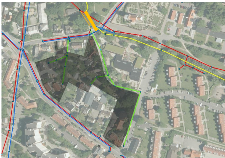
Figur 2 Bevaring af fællessystemet. Den orange ledning skal opdimensioneres og de grønne ledninger renoveres ved opgravning.
