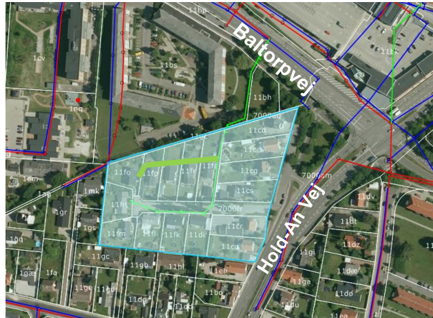
Figur 1 Området ved Vestermarken. Fællessystemet er vist med grøn. Ledningen markeret med 'fed grøn' er fælles privat.
