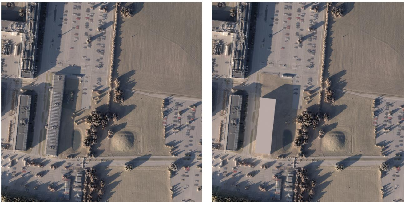
Figur 4: Skyggestudie af tidligere (A) og fremtidige (B) forhold, 21. marts kl 17. Det er i det tidlige forår, at skygge er kritisk for opvarmning af søen og det er primært på dette tidspunkt, at der er forskel på arealet af søen som skygges af hhv. eksisterende og ny bygning. Tidligere forhold (A) er opmålt ved lidar overflyvning i april 2019, mens fremtidige forhold (B) er baseret på tagfladen i kote 50.
