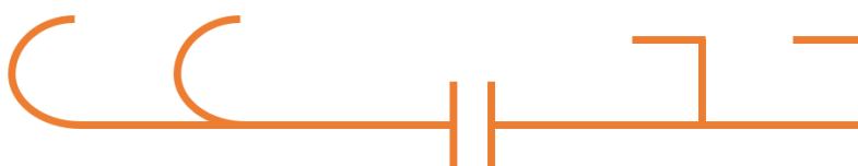
Figur 4-8 En illustration af princippet med dobbelt tilbagebukkede ender på paddehegn. Enderne kan enten laves med buede eller kantede tilbagebuk som det ses hhv. til venstre og højre.
