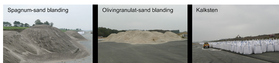
Figur 2. Filtermaterialer anvendt i anlæggene.
