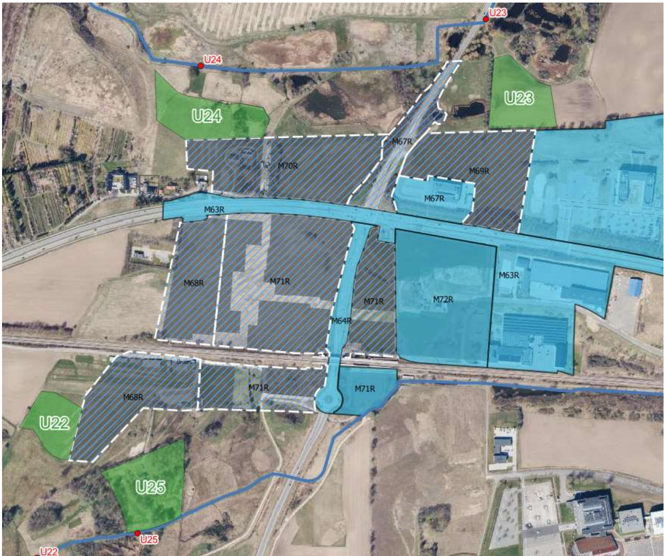
Figur 8 Arealreservation for Novafos's regnvandsbassiner og udløbsnummer
