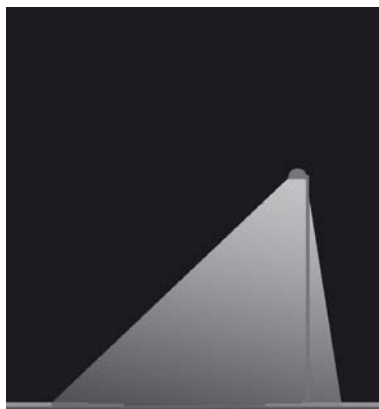
Ensidet masteanlæg. Her er masten optimalt placeret mellem cykelsti og fortov.
