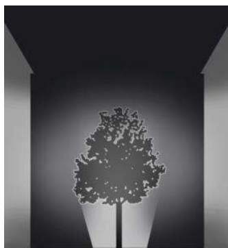
Belysning af vertikale elementer såsom træer skaber rumlighed i byrummet. Træer belyses bedst nedefra så lyset aftager opad til
