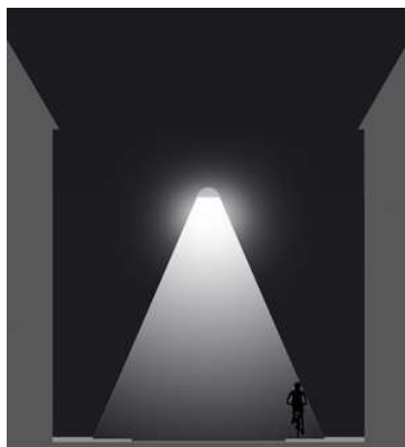
Ældre eller dårligt udførte belysningsanlæg er ofte kendetegnet ved blændende armaturer og ved at lyset primært rammer kørebanelaget mens de bløde trafikanter er henvist til mørket.
