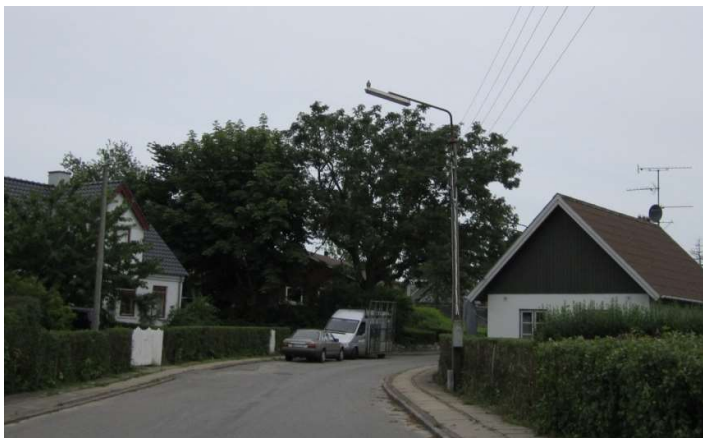
Lange mastearme og høje master dominerer byrummet negativt og skal undgås.
