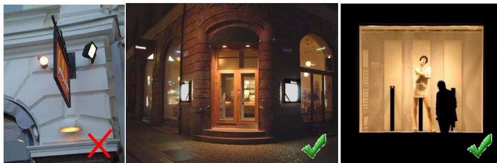
Eksempler på skilte-, indgangs- og butiksbelysning. Første billede viser skiltebelysning med dårligt tilpasset og blændende armaturer. Andet billede viser en indbydende indgangsbelysning, som ikke blænder. Tredje billede viser et udstillingsvindue med tilpasset belysningsniveau og uden blænding af den forbigående.
