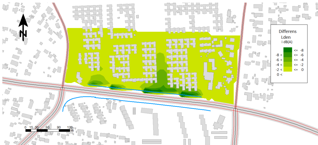
Figur 23: Differens kort. Figuren viser effekten af etablering af en 3 m høj støjskærm langs med Ballerup Byvej. Beregningshøjde 1,5 m over terræn.
