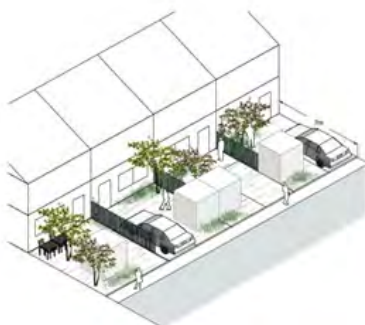
Kantzone 3 - Princip for forhaver ved rækkehuse
