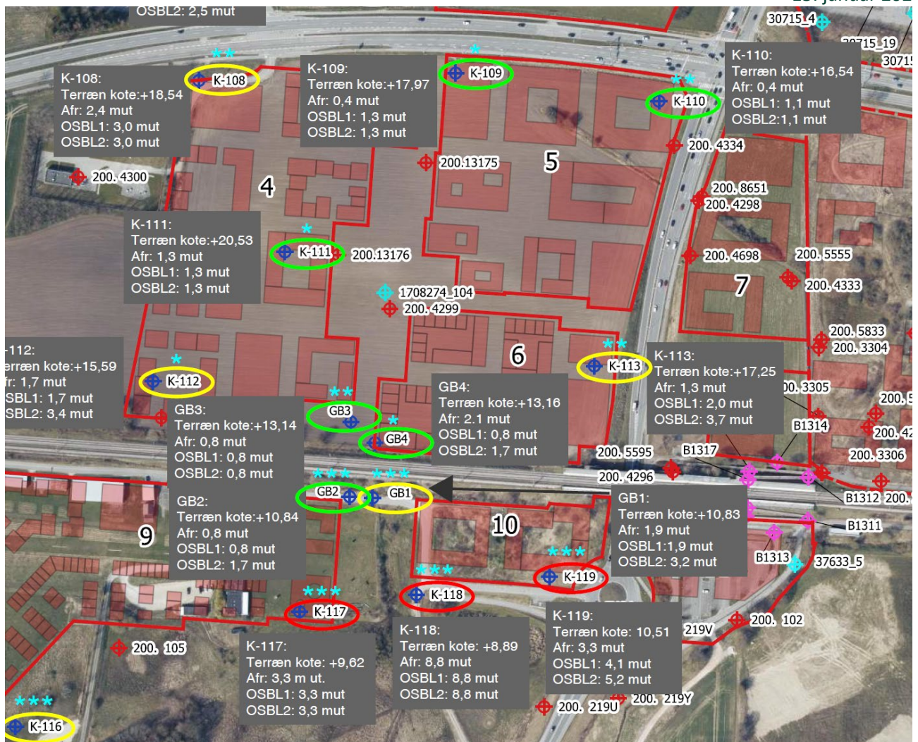
Figur 4.1.4 Oversigtsplan over indledende geotekniske undersøgelser af Kildedal By
