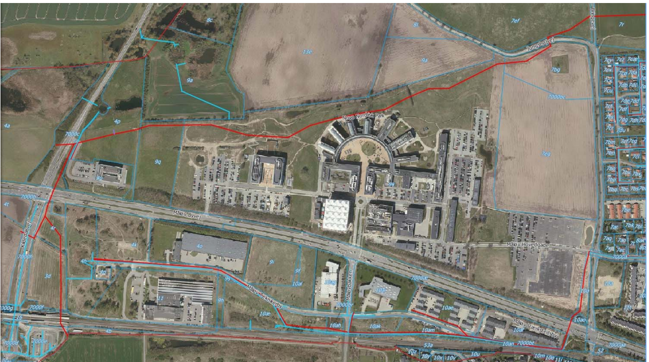
Større spildevandsledninger (rød) og regnvandsledninger (lysblå)
