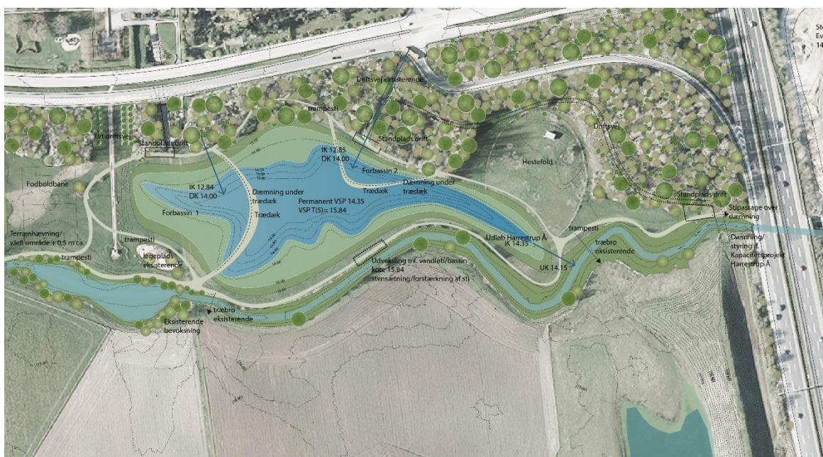
Figur 1 Regnvandsbassin, permanent vådt volumen. 7.900 m 3 , kote 14,35 m DVR90.
