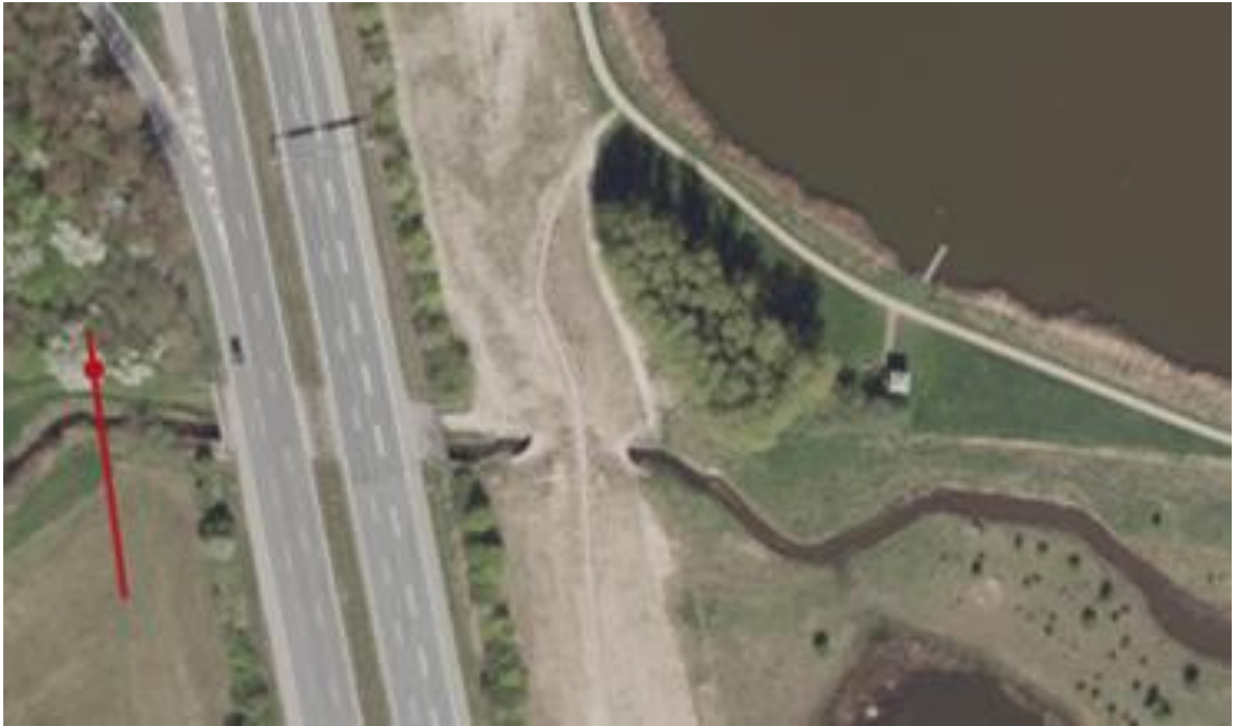
Figur 15 Placering af dæmning/sluse og tværsnit af eksisterende terræn ved linjeføringen. Rød linje på oversigtskortene svarer til snitlinjen mens rød prik på linjen svarer til rød prik i tværsnittet. Den røde prik på tværsnittet markerer hvor eksisterende terræn er i kote 16,25 m DVR90 svarende til sikringsniveauet for dæmningen.
