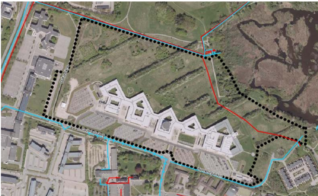
Større spildevandsledninger (rød) og regnvandsledninger (lysblå)
