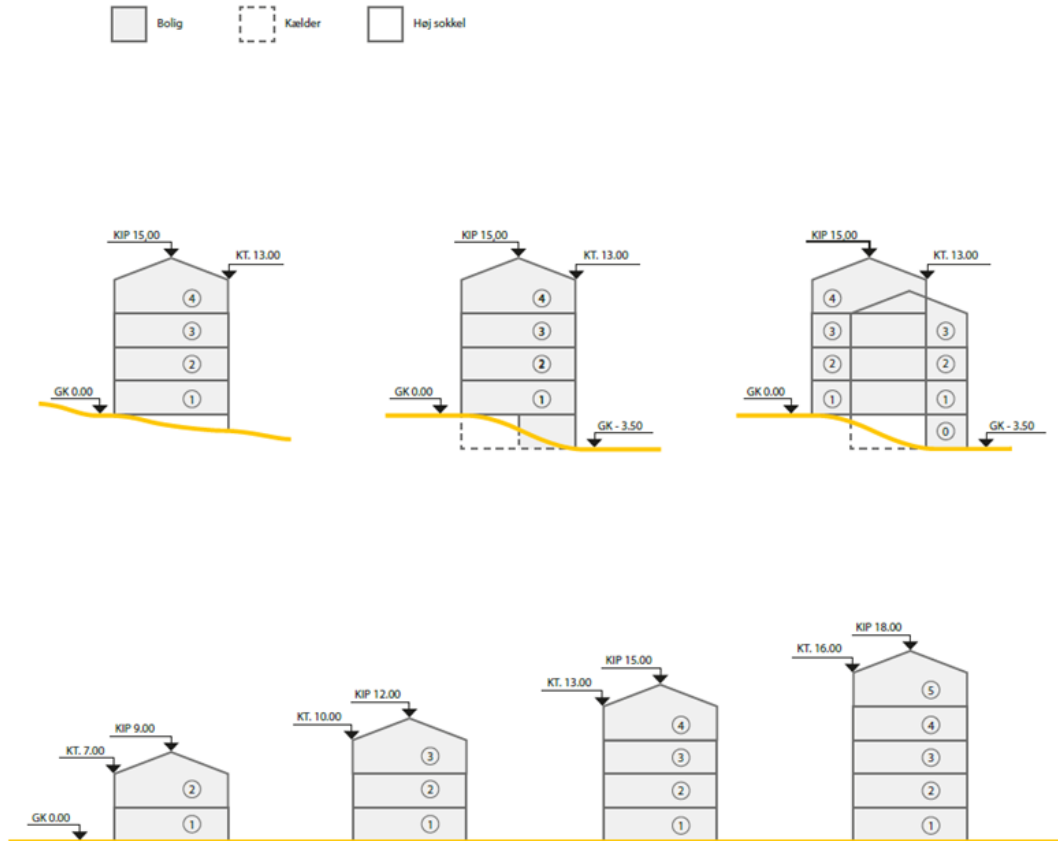
Princip for bygningshøjder
