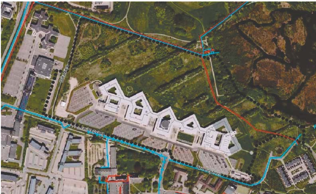
Større spildevandsledninger (rød) og regnvandsledninger (lysblå)
