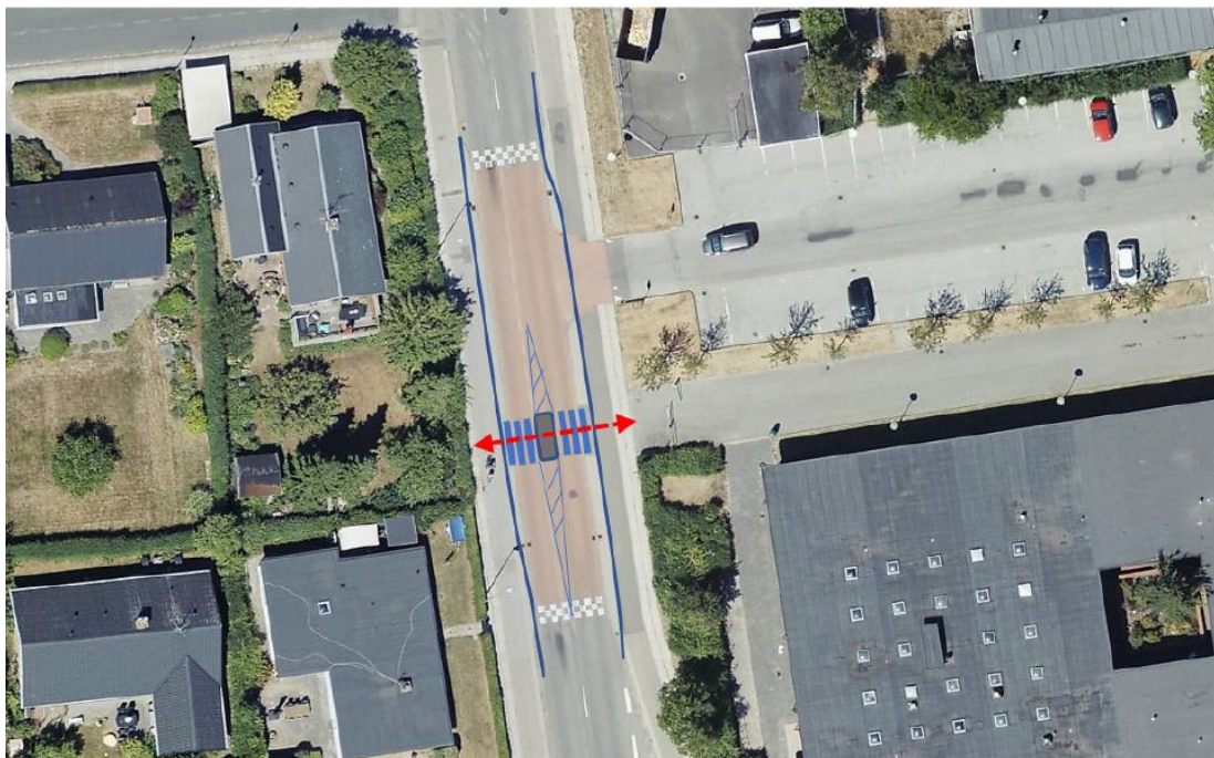
Figur 6: Idéskitse af midterhelle på den hævede flade
