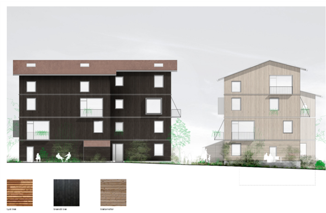
Illustrativt eksempel på facadeudsnit med det gennemgående materiale i træ.
