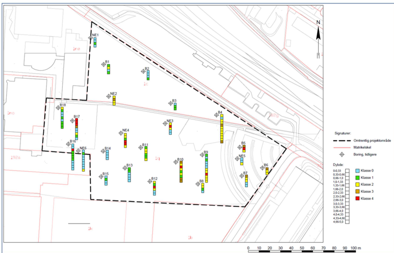
Figur Z1. Oversigt over boringer og jordklasser
