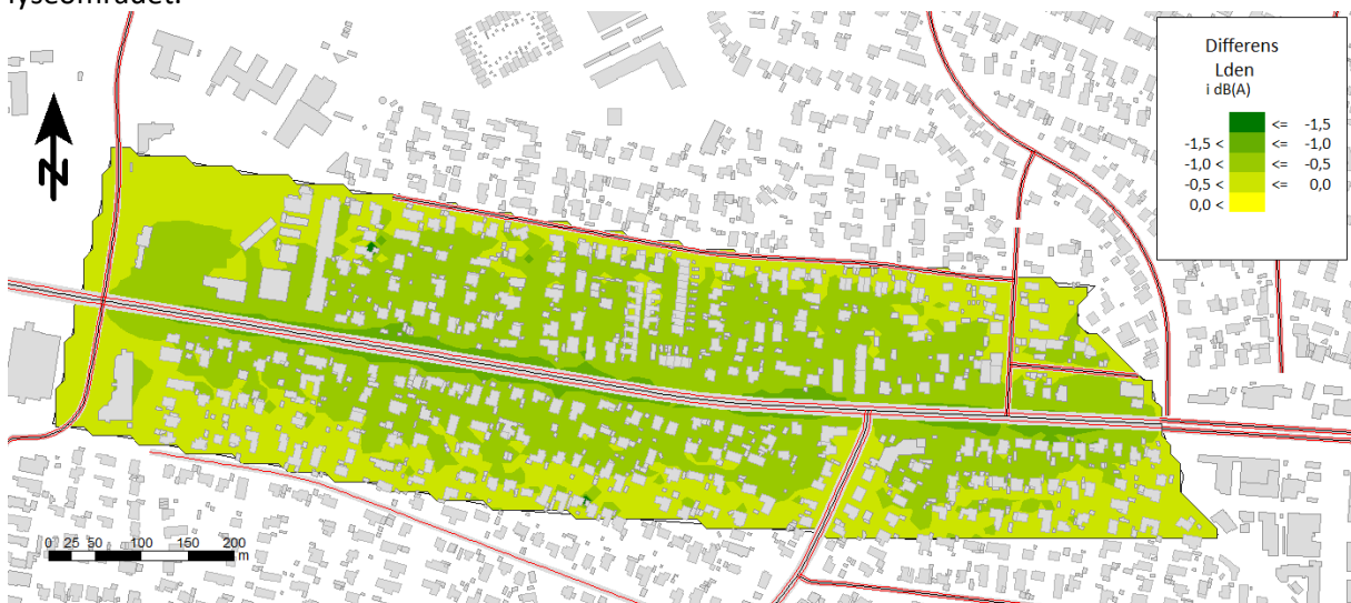
Figur 20: Differenskort. Figuren viser effekten af at nedsættes hastigheden på Skovlunde Byvej til 50 km/t. Beregningshøjde 1,5 m over terræn.
