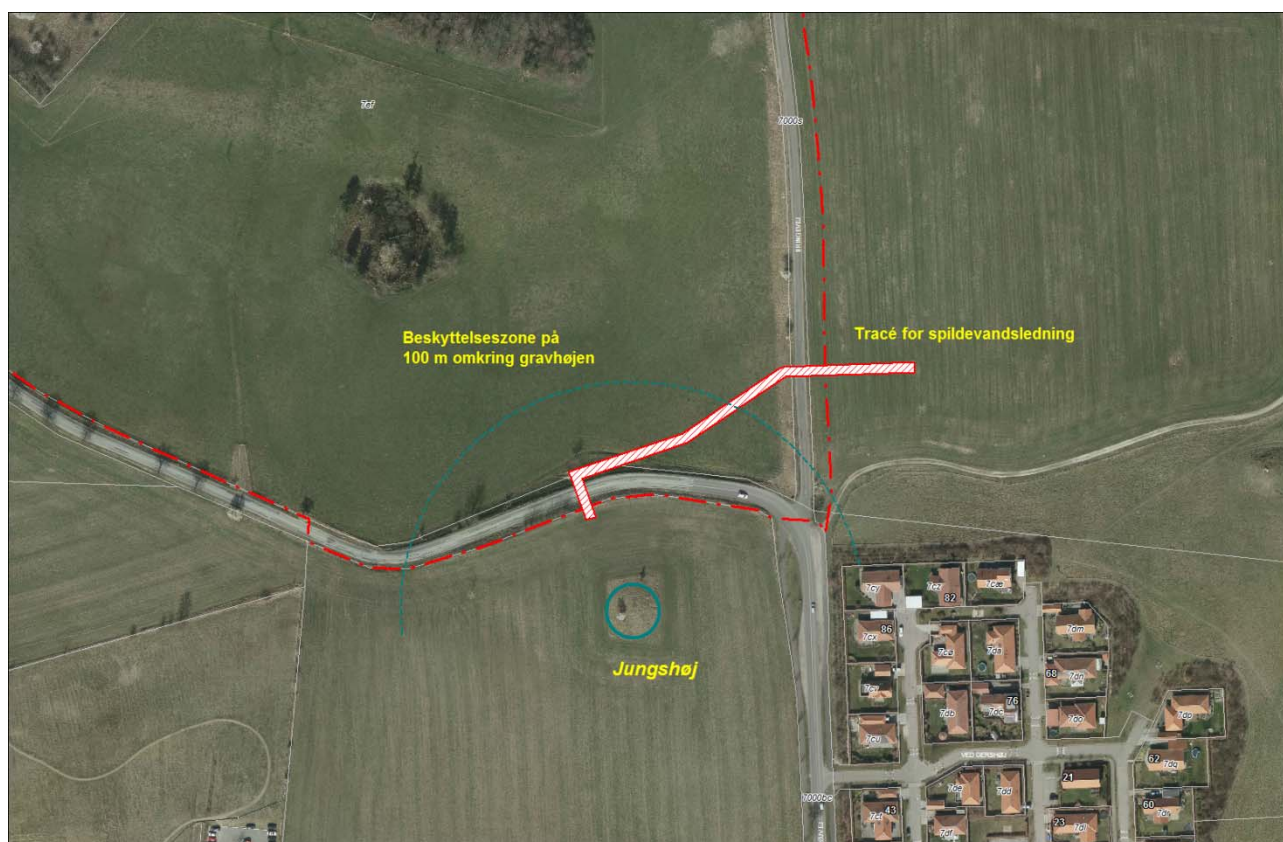
Beskyttelseszone og eksisterende kloakledning
